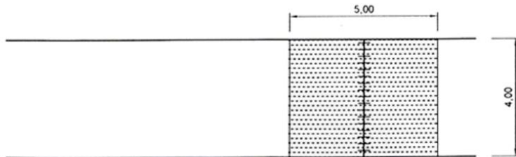
figura 3 scavo trasversale alla carreggiata
